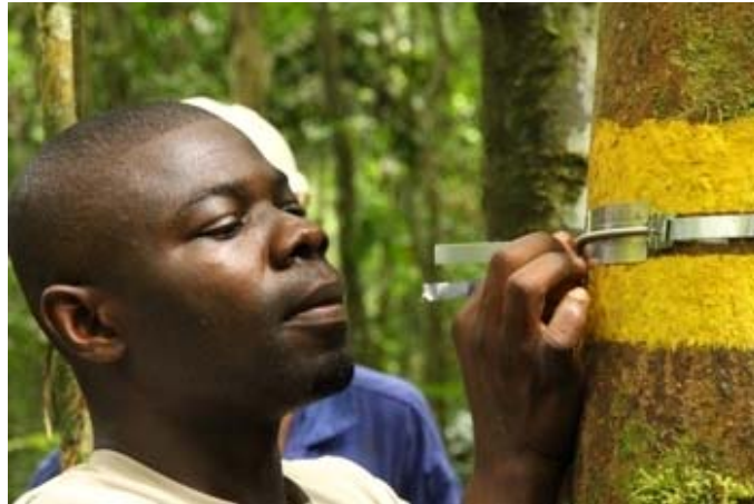
Le doctorant Achille Biwolé installe un dendromètre sur une tige d'azobé.
