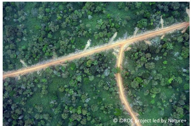
Les photos aériennes géo-localisées permettent de mesurer la largeur des routes, des pistes de débardage et des trouées, et de détecter les campements illégaux (photo de gauche)
